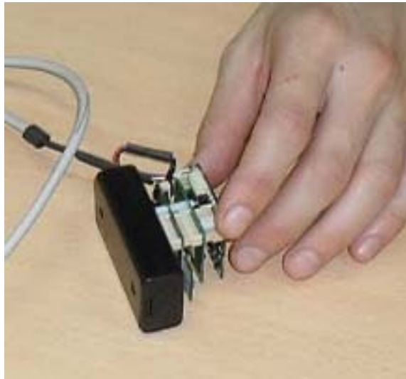
Ilustración 6.2 Nodo sensor iSense con porta baterías y cable USB
