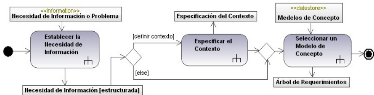
Figura 8.6. Flujo de actividades del proceso de Definición de Requerimientos no Funcionales (Fuente [Becker et al., 2009])
